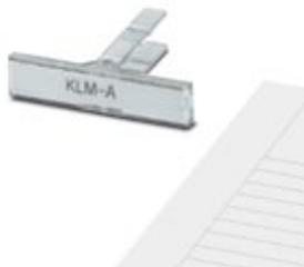
Klemmenleistenmarker, zur Leistenkennzeichnung, höhenverstellbar, zu verwenden bei Endhaltern E/UK, E/NS 35 N, oder CLIPFIX 35, Schriftfeldgröße: 44 x 7 mm
