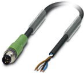
Sensor-/Aktor-Kabel, 4-polig, PUR halogenfrei, schwarzgrau RAL 7021, Stecker gerade M8, auf freies Leitungsende, Kabellänge: 3 m
