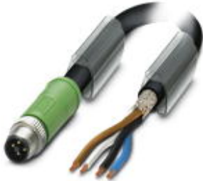
Sensor-/Aktor-Kabel, 4-polig, PUR halogenfrei, schwarz RAL 9005, geschirmt, Stecker gerade M12 SPEEDCON, T-kodiert, auf freies Leitungsende, Kabellänge: 5 m
