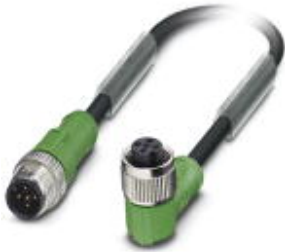
Sensor-/Aktor-Kabel, 5-polig, PUR halogenfrei, schwarzgrau RAL 7021, Stecker gerade M12, A-kodiert, auf Buchse gewinkelt M12, A-kodiert, Kabellänge: 3 m
