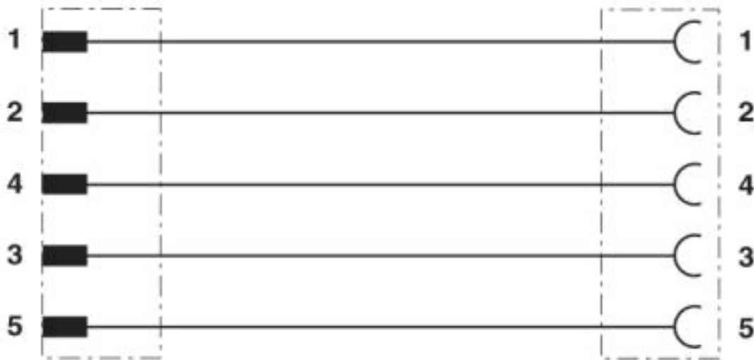
Kontaktbelegung des M12-Stecker und der M12-Buchse
