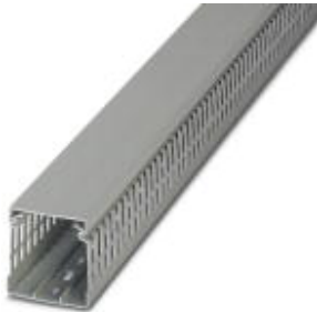
Verdrahtungskanal, lichtgrau, halogenfrei, bestehend aus Ober- und Unterteil, Breite: 60 mm, Höhe: 80 mm, Länge: 2000 mm
