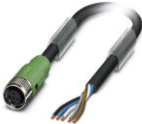
Sensor-/Aktor-Kabel, 5-polig, PUR, schwarzgrau RAL 7021, freies Leitungsende, auf Buchse gerade M12 SPEEDCON, A-kodiert, Kabellänge: 2 m
