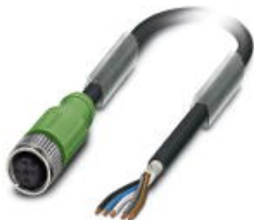
Sensor-/Aktor-Kabel, 5-polig, PUR halogenfrei, schwarzgrau RAL 7021, geschirmt, freies Leitungsende, auf Buchse gerade M12, A-kodiert, Kabellänge: 5 m
