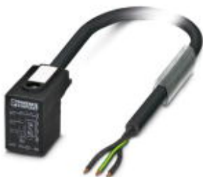
Sensor-/Aktor-Kabel, 3-polig, PUR halogenfrei, schwarzgrau RAL 7021, freies Leitungsende, auf Ventilstecker B (10 mm), mit 1 LED, beschaltet mit Z-Diode, Kabellänge: 3 m
