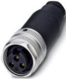
Sensor-/Aktor-Stecker, Buchse, gerade, 3-polig, 7/8", Schraubanschluss, Metallrändel, Kabelverschraubung Pg9
