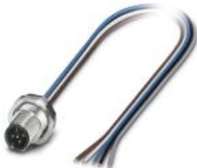
Sensor-/Aktor-Einbaustecker, 5-polig, M12, A-kodiert, Hinterwand-/Schraubmontage mit Pg9-Gewinde, mit 0,5 m TPE-Litze, 5x 0,34 mm<sup>2</sup>
