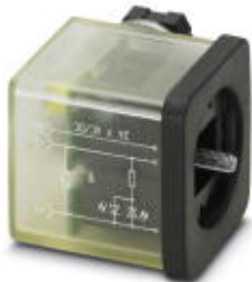
Ventilstecker, 3-polig, Bauform A, 1 LED, mit Schutzbeschaltung, Schraubanschluss, Kabelverschraubung M16
