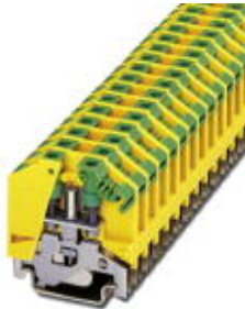
Schutzleiter-Universalklemme mit Bolzen-Anschluss, Querschnitt: 0,1 - 2,5 mm 2 , Breite: 9 mm, Farbe: grün-gelb
