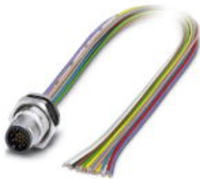
Sensor-/Aktor-Einbaustecker, 17-polig, M12-SPEEDCON, Hinterwand-/Schraubmontage mit M16 Gewinde, mit 0,5 m halogenfreier TPE-Litze, 17 x 0,14 mm 2
