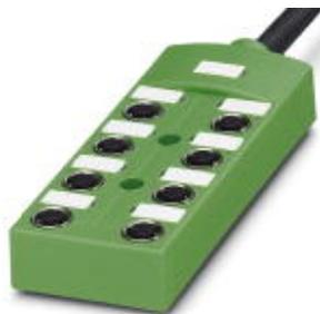
Sensor-/Aktor-Box, Anschlussart: M12-SPEEDCON-Buchse Metall, Anzahl der Steckplätze: 8, Polzahl: 5, Steckplatzbelegung: doppelt, Statusanzeige: Nein, Universal; Stammlenitungsanschluss: Festanschluss 180°, PUR/PVC, Leitungslänge: 5 m, Schirmung: nein
