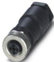
Steckverbinder, 4-polig, Buchse gerade M12, T-kodiert, Schraubanschluss, Rändelmaterial: Zinkdruckguss, vernickelt, Kabelverschraubung Pg11, Kabelaußendurchmesser 8 mm ... 10 mm
