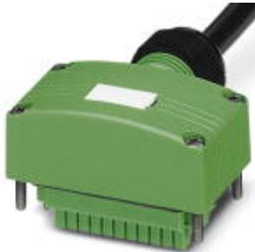
Anschlusshaube, verwendbar für Sensor-/Aktor-Box, Anschlussart: M12-SPEEDCON-Buchse Metall, Anzahl der Steckplätze: 4, Steckplatzbelegung: doppelt, Statusanzeige: Nein; Stammleitungsanschluss: Steckbarer Schraubanschluss 180°, PUR/PVC, Leitungslänge: 10 m, Schirmung: nein
