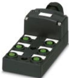
Sensor-/Aktor-Box, Anschlussart: M12-SPEEDCON-Buchse Kunststoff, Anzahl der Steckplätze: 6, Polzahl: 5, Steckplatzbelegung: doppelt, Statusanzeige: Ja, pnp; Stammleitungsanschluss: Federkraftanschluss 180°, Schirmung: nein
