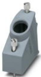
Tüllengehäuse, aus Kunststoff, mit metrischem Kabelabgang, Verriegelungsschrauben mit Rändelkopf, Bauform: VC2, Kabelverschraubung: M25
