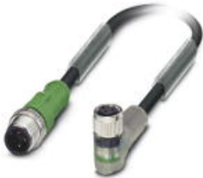
Sensor-/Aktor-Kabel, 3-polig, PUR halogenfrei, schwarzgrau RAL 7021, Stecker gerade M12, A-kodiert, auf Buchse gewinkelt M8, mit 2 LEDs, Kabellänge: 1,5 m
