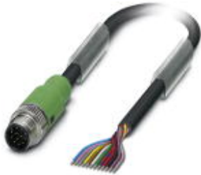
Sensor-/Aktor-Kabel, 12-polig, PUR halogenfrei, schwarz RAL 9005, Stecker gerade M12 SPEEDCON, A-kodiert, auf freies Leitungsende, Kabellänge: 10 m
