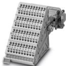
HEAVYCON Klemmenadapter Steckereinsatz, Serie D40, 40-polig, PE-Anschluss rechts für die linke Schaltschrankseite, Push-in-Anschluss
