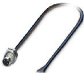
Sensor-/Aktor-Einbaustecker, 3-polig, M8, Hinterwand-/Schraubmontage mit M8-Gewinde, mit 0,5 m TPE-Litze, 4 x 0,25 mm 2
