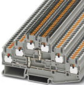
Mehrstock-Klemme, Anschlussart: Push-in-Anschluss, Querschnitt: 0,14 mm 2 - 4 mm 2 , AWG: 26 - 12, Breite: 5,2 mm, Farbe: blau, Montageart: NS 35/7,5, NS 35/15
