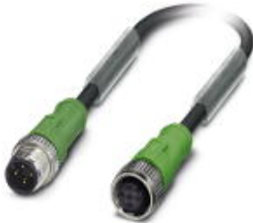
Sensor-/Aktor-Kabel, 4-polig, PUR halogenfrei, schwarzgrau RAL 7021, Stecker gerade M12, A-kodiert, auf Buchse gerade M12, A-kodiert, Kabellänge: 2 m
