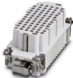
HEAVYCON Buchseneinsatz, Serie DD72, 72-polig, 73 ... 144 bedruckt, Crimpanschluss. PE-Anschluss mittels Zughülstechnik.
