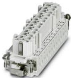
HEAVYCON Buchseneinsatz, Serie B24, 24-polig, 25 ... 48 bedruckt, Schraubanschluss. PE-Anschluss mittels Zughülstechnik.
