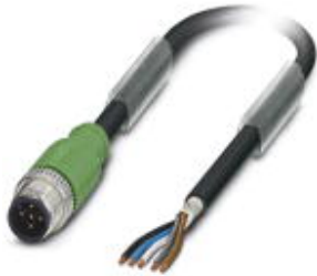
Sensor-/Aktor-Kabel, 5-polig, PUR halogenfrei, schwarzgrau RAL 7021, geschirmt, Stecker gerade M12, A-kodiert, auf freies Leitungsende, Kabellänge: 10 m
