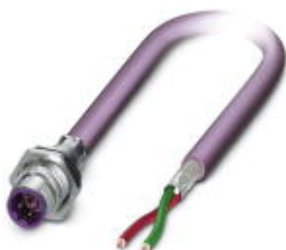
Bus-System-Einbaustecker, PROFIBUS, 2-polig, M12, geschirmt, B-kodiert, SPEEDCON, Hinterwand-/Schraubmontage mit Pg9-Gewinde, mit 2,0 m Buskabel, 2x 0,25 mm 2
