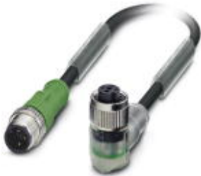
Sensor-/Aktor-Kabel, 3-polig, PUR halogenfrei, schwarzgrau RAL 7021, Stecker gerade M12, A-kodiert, auf Buchse gewinkelt M12, A-kodiert, mit 2 LEDs, Kabellänge: 2 m
