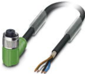
Sensor-/Aktor-Kabel, 4-polig, PUR halogenfrei, schwarzgrau RAL 7021, geschirmt, freies Leitungsende, auf Buchse gewinkelt M12, A-kodiert, Kabellänge: 10 m
