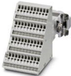
HEAVYCON Klemmenadapter Buchseneinsatz, Serie D40, 40-polig, PE-Anschluss rechts für die linke Schaltschrankseite, Schraubanschluss
