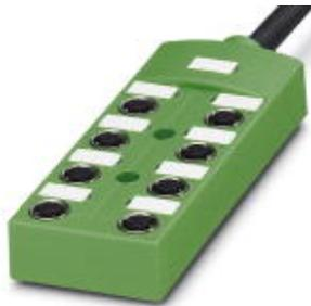
Sensor-/Aktor-Box, Anschlussart: M12-SPEEDCON-Buchse Metall, Anzahl der Steckplätze: 8, Polzahl: 5, Steckplatzbelegung: doppelt, Statusanzeige: Nein, Universal; Stammlenitungsanschluss: Festanschluss 180°, PUR/PVC, Leitungslänge: 10 m, Schirmung: nein
