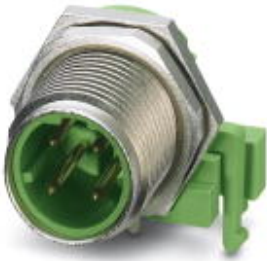
Bussystem-Einbausteckverbinder, Stecker, ETHERNET, 4-polig, M12, geschirmt, D-kodiert, Hinterwand-/Schraubmontage, mit gewinkeltem Lötanschluss
