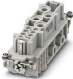
HEAVYCON Buchseneinsatz, Serie K4/8, für 4 Leistungs- und 8 Steuerkontakte, Schraubanschluss ohne Drahtschutz
