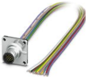
Sensor-/Aktor-Einbaustecker, 17-polig, M12, A-kodiert, Vorderwand-/Vierkantflanschmontage, mit 0,5 m TPE-Litze, 17 x 0,14 mm 2
