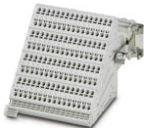
HEAVYCON Klemmenadapter Buchseneinsatz, Serie D64, 64-polig, PE-Anschluss rechts für die linke Schaltschrankseite, Push-in-Anschluss
