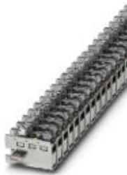
Abzweigklemme, Anschlussart Schraubanschluss, Belastungsstrom: 125 A, Querschnitt: 0,75 mm 2 - 35 mm 2 , Breite: 12 mm, Farbe: aluminium
