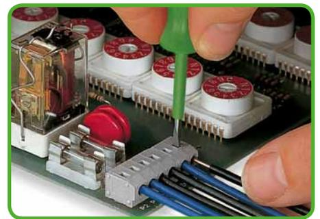
Leiter lösen mit Schraubendreher 2,5 mm x 0,4 mm.
