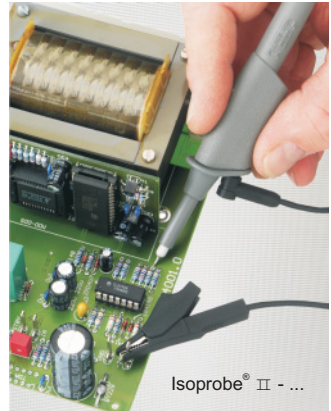
Passiver Tastkopf, hohe Eingangskapazität
