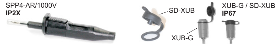
Beispiele für Schutzarten. Links: Prüfspitze SPP4-AR/1000V mit zurückschiebbarer Isolierhülse: Schutzart IP2X Rechts: Universalbuchse XUB-G mit Schutzdeckel SD-XUB: Schutzart IP67
