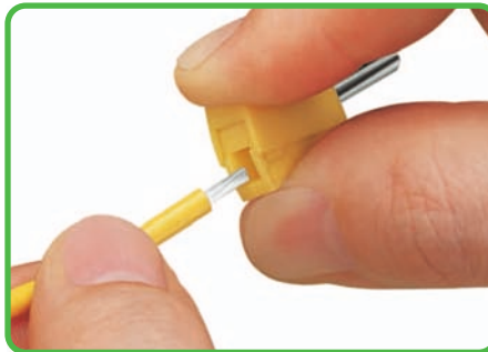
Leiter anschließen: Gehäuse an der eckigen Öffnung zusammendrücken und Leiter einführen.
