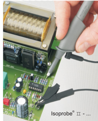
Passiver Tastkopf, hohe Eingangskapazität
