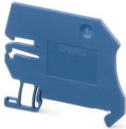
Auflagebock, Halterung für Sammelschienen, alle 20 cm zu setzen, Länge: 58,4 mm, Breite: 2,2 mm, Höhe: 46,9 mm, Farbe: blau
