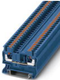
Durchgangsklemme, Anschlussart: Push-in-Anschluss, Querschnitt: 0,14 mm 2 - 4 mm 2 , AWG: 26 - 12, Breite: 5,2 mm, Höhe: 35,3 mm, Farbe: blau, Montageart: NS 35/7,5, NS 35/15
