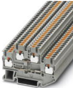
Doppelstock-Klemme, Querschnitt: 0,14 mm 2 - 4 mm 2 , AWG: 26 - 12, Anschlussart: Push-in-Anschluss, Breite: 5,2 mm, Farbe: grau, Montageart: NS 35/7,5, NS 35/15
