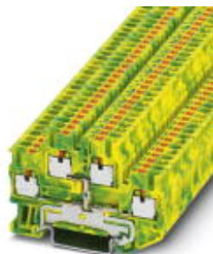
Schutzleiter-Doppelstockklemme, Querschnitt: 0,14 mm 2 - 4 mm 2 , AWG: 26 - 12, Anschlussart: Push-in-Anschluss, Breite: 5,2 mm, Farbe: grün-gelb, Montageart: NS 35/7,5, NS 35/15
