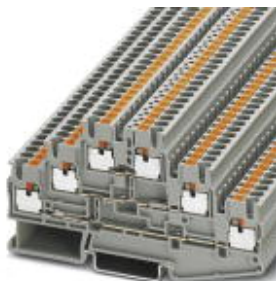
Mehrstock-Klemme, Querschnitt: 0,14 mm 2 - 4 mm 2 , AWG: 26 - 12, Anschlussart: Push-in-Anschluss, Breite: 5,2 mm, Farbe: grau, Montageart: NS 35/7,5, NS 35/15
