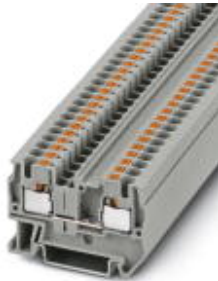
Durchgangsklemme, Anschlussart: Push-in-Anschluss, Querschnitt: 0,2 mm 2 - 6 mm 2 , AWG: 24 - 10, Breite: 6,2 mm, Höhe: 35,3 mm, Farbe: grau, Montageart: NS 35/7,5, NS 35/15
