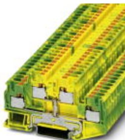
Schutzleiter-Doppelstockklemme, Querschnitt: 0,2 mm 2 - 6 mm 2 , AWG: 24 - 10, Anschlussart: Push-in-Anschluss, Breite: 6,2 mm, Farbe: grün-gelb, Montageart: NS 35/7,5, NS 35/15
