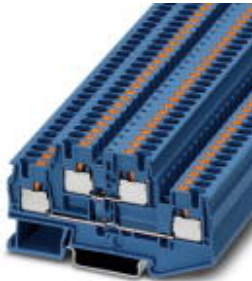
Doppelstock-Klemme, Querschnitt: 0,2 mm 2 - 6 mm 2 , AWG: 24 - 10, Anschlussart: Push-in-Anschluss, Breite: 6,2 mm, Farbe: blau, Montageart: NS 35/7,5, NS 35/15
